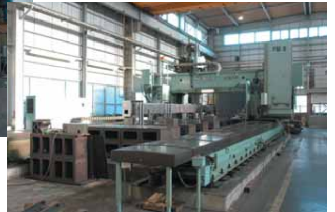
製紙機械のフレーム部分を加工するためのNCマシン。
