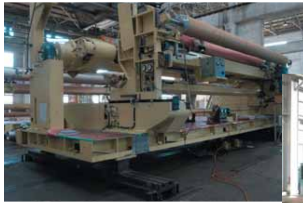
ワインダーと呼ばれるフィルムを巻き取るための機械の組み立て風景。写真の製品は、台湾に輸出する光学フィルム巻き取り用のもの。
